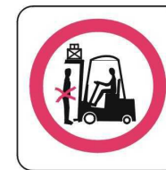
SP-250 PROHIBIDO SITUARSE DEBAJO DE LA CARGA
