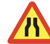
TP-17 ESTRECHAMIENTO DE CALZADA
