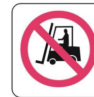
SP-210 PROHIBIDO EL PASO A CARRETILLAS
