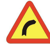
TP-13 a CURVA PELIGROSA HACIA LA DERECHA
